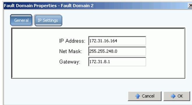
Ilustración 139. Configuración IP de puerto de control iSCSI
